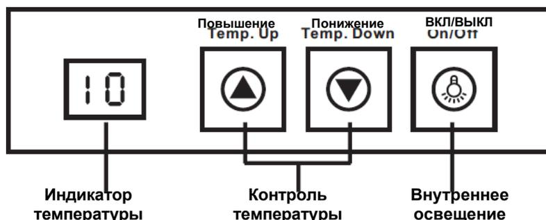
Диапазон температур холодильника составляет от 8°C до 14°C. Когда температура установлена на определенное значение и температура внутри достигает этого значения, включается автоматическая система контроля температуры, и система охлаждения переходит в режим линейного поддержания температуры.
