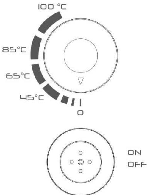
С помощью шкалы установите нужную температуру от 000 (нормальная температура воды) и 100°С.
